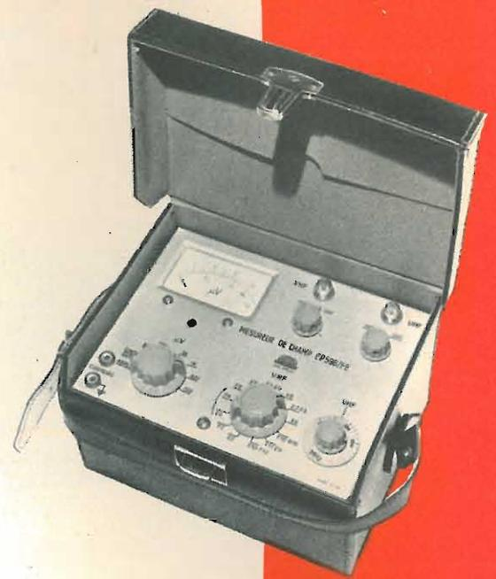
**Campo di frequenza:** VHF tutti i canali TV e FM; UHF 470 ÷ 830 MHz.
